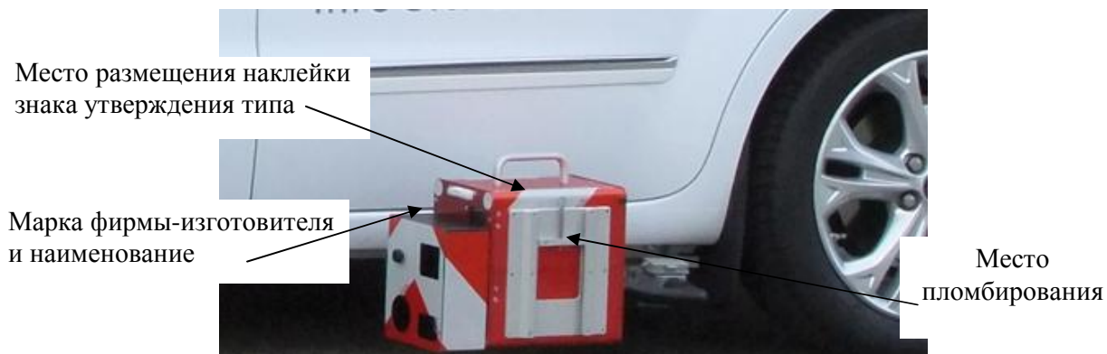
Рисунок 3 – Ретрорефлектометр ZDR 6020, обозначение мест маркировки и пломбирования
