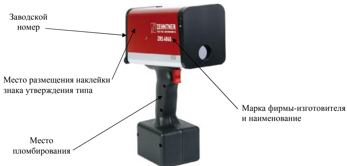
Рисунок 4 – Ретрорефлектометр ZRS 6060, обозначение мест маркировки и пломбирования
