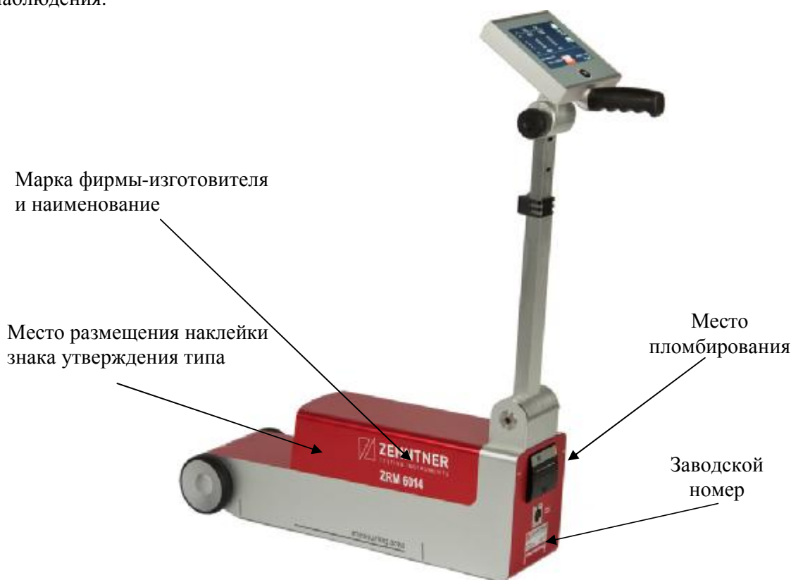
Рисунок 1 – Ретрорефлектометр ZRM 6014, обозначение мест маркировки и пломбирования
